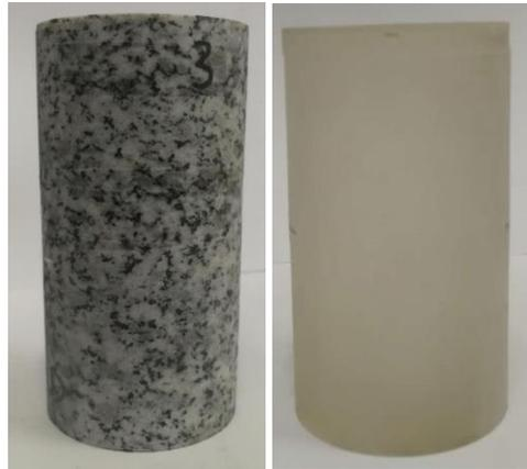
(d) granite sample and epoxy resin sample
