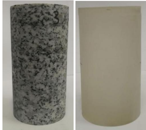
(d) granite sample and epoxy resin sample
